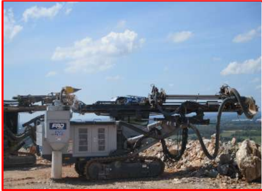
(12) เครื่องเจาะที่ติดตั้งเครื่องดูดฝุ่นและถังพักฝุ่น
